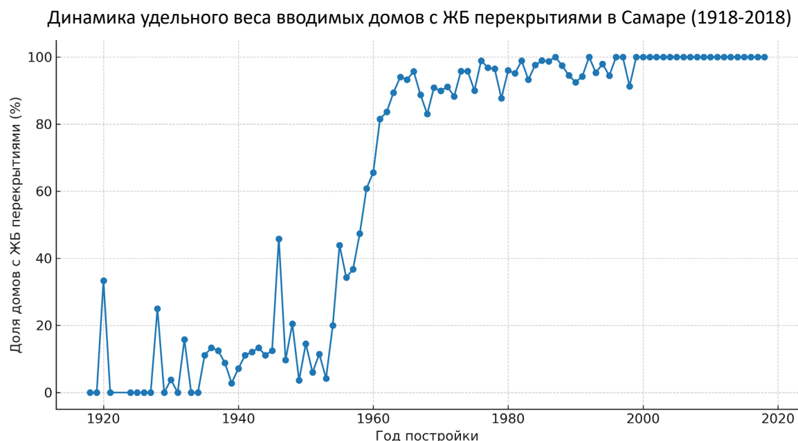
Рис. 36. Затянутое замещение деревянных перекрытий железобетонными в конце К4
